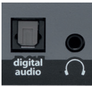
Kuva 10. Audioliitännät – optinen vasemmalla ja 3,5 mm oikealla.
