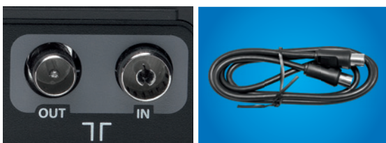
Kuva 3: Digiboksin antenniliitännät ja antennikaapeli.
