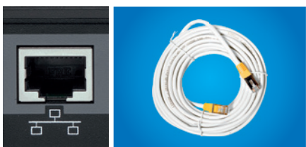
Kuva 4. Digiboksin verkkoliitin ja verkkokaapeli.
