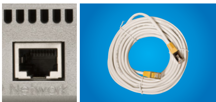
Kuva 4. Digiboksin verkkoliitin ja verkkokaapeli.
